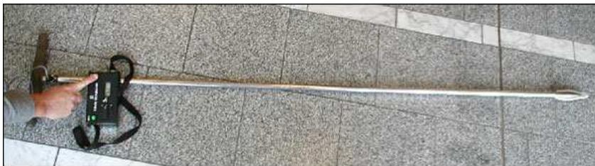
*Bild 1.13: Heumesssonde, mit der die Temperatur im Inneren des Heustocks überwacht werden kann.*
